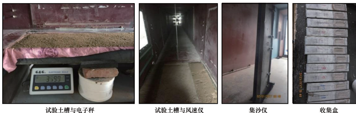
图3 风洞试验装置
