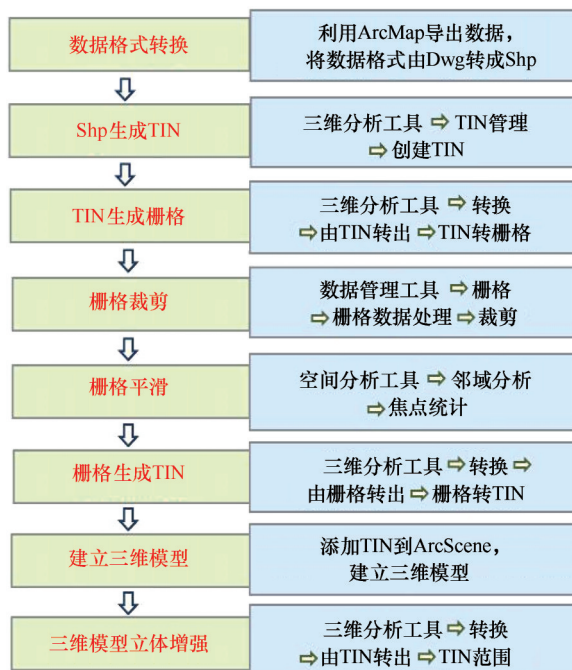
图4 单个沙丘三维模拟技术路线
