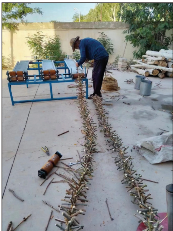
图9 刷状沙柳沙障机械化生产过程
