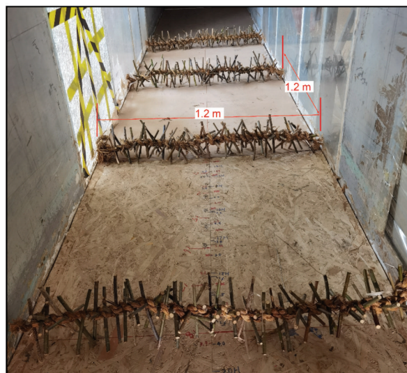
图1 沙柳沙障风洞布设
