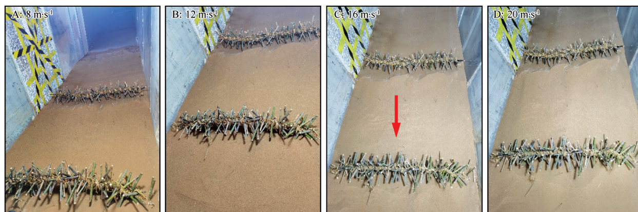
图5 刷状沙柳沙障对流沙表面蚀积的影响(箭头所示为风向)
